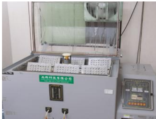
酸雨测试设备 (执行规范德国标准DIN-50018)
