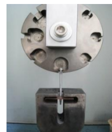
拉拔力破坏测试
